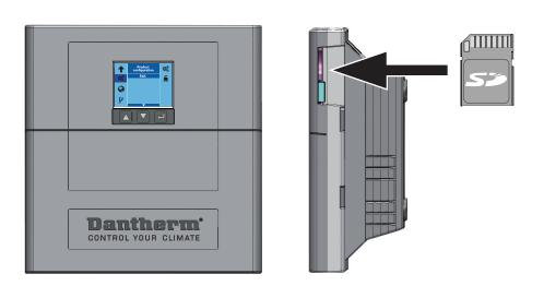
Zur Inbetriebnahme SD-Karte in den Schlitz an der Seite der CC3000-Steuerung einstecken. Dann die Konfigurationsdatei für die FB 900 auswählen.
