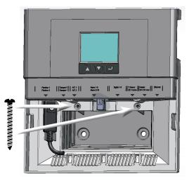
Hauptteil mit zwei Schrauben am Gehäuse der Wandhalterung sichern.
